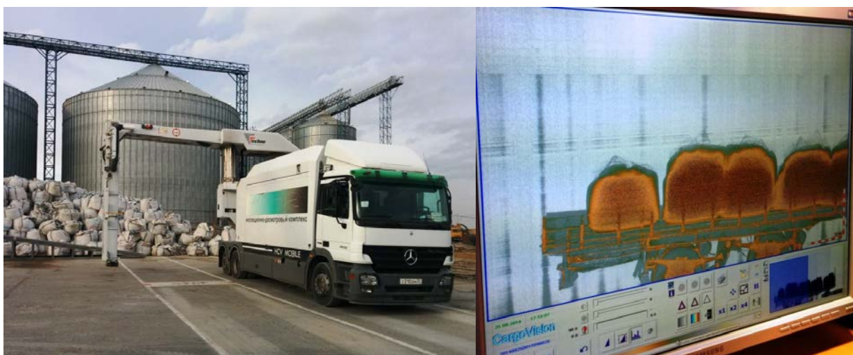
Контроль мобильным ИДК (цемент загрузка 1500 кг)
