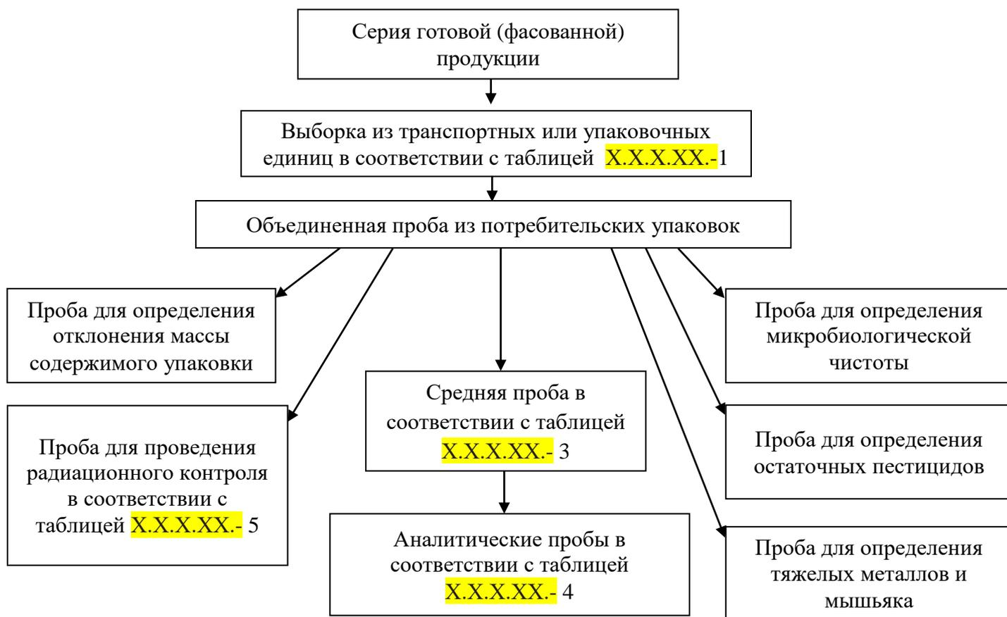
Рисунок X.X.X.XX.-2 – Схема порядка отбора проб от серии ЛРП
