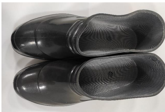
Рисунок 24 – Образец, изготовленный из вулканизированного бутадиен-стирольного каучука
