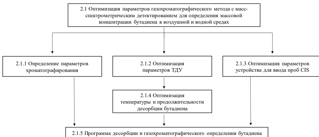
Рисунок 4 – Схема оптимизации параметров хроматографирования и десорбции бутадиена
