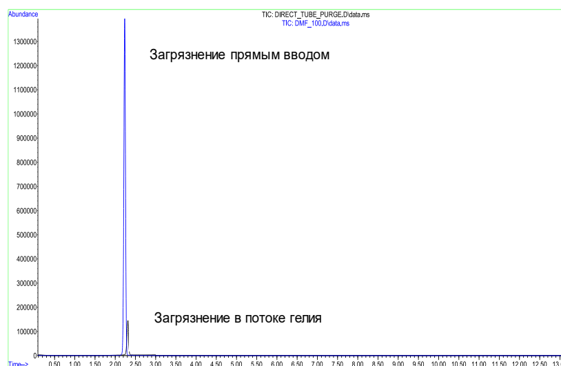
Рисунок 13 – Хроматограммы, полученные с использованием различных методов загрязнения сорбционной трубки
