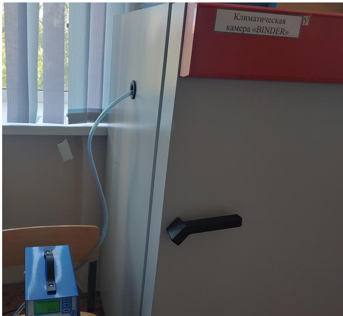
Рисунок 17 – Общий вид климатической камеры с подключенным аспиратором
