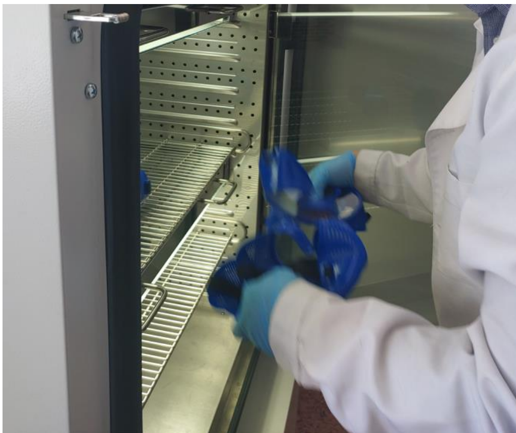
Рисунок 18 – Помещение образцов защитных очков
