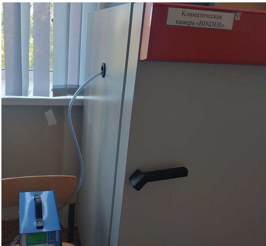
Рисунок 17 – Общий вид климатической камеры с подключенным aspirатором
