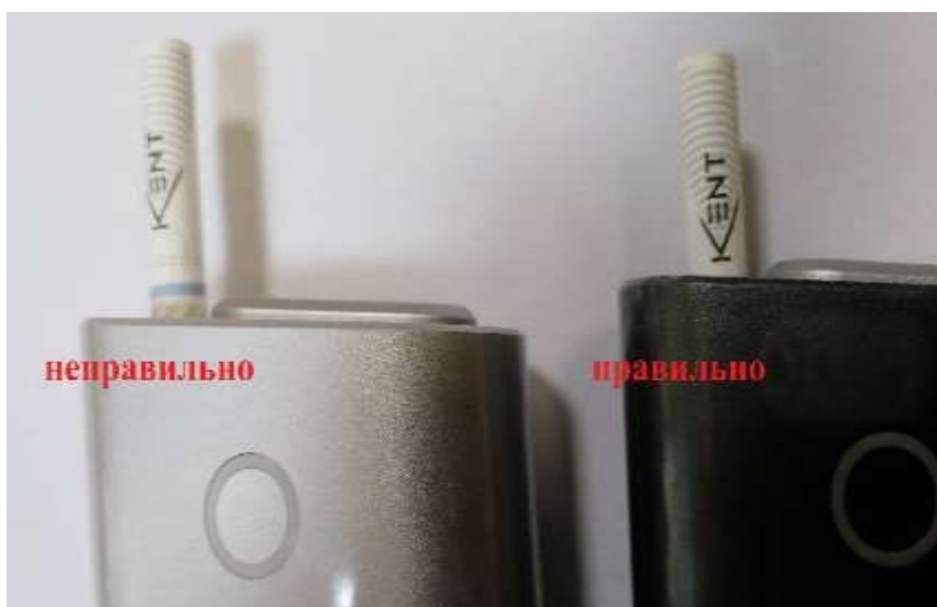
Рисунок 21 – Правильная установка изделия с нагреваемым табаком (табака нагреваемого) – стика в СНТ Glo
