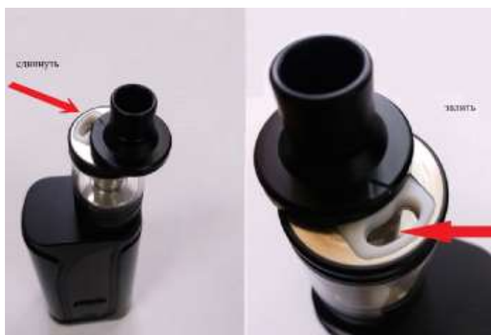
Рисунок 14 – Заправка емкости (бака) жидкостью для СДН
