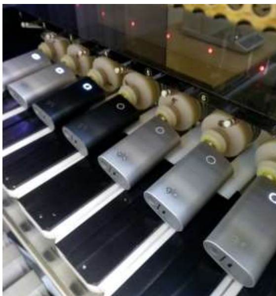
Рисунок 22 – Сбор аэрозоля изделий с нагреваемым табаком (табака нагреваемого) – стиков Glo на курительной машине Cerulean SM450
