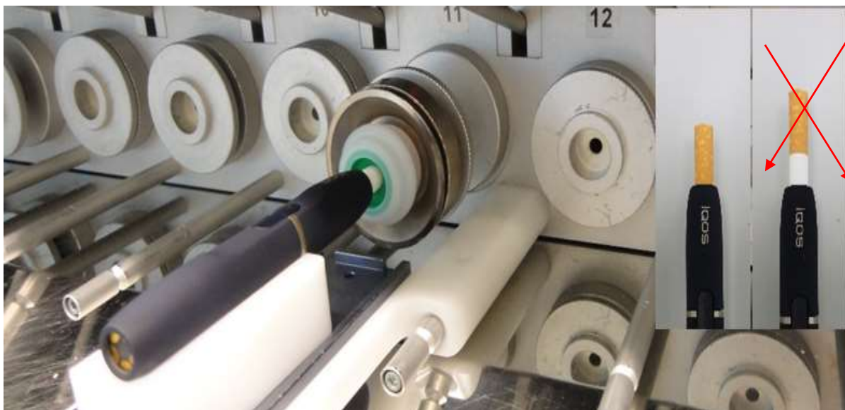
Рисунок 20 – Сбор аэрозоля изделий с нагреваемым табаком (табака нагреваемого) – стиков для IQOS™ 2.4P на курительной машине Cerulean SM450
