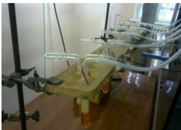
Рисунок 24 – Улавливание компонентов карбонильной группы с помощью барботера, присоединенного к курительной машине
