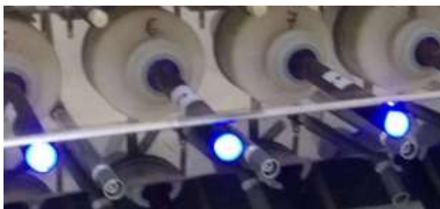
Рисунок 27 – Одноразовые СДН LUXLITE на курительной машине в момент затяжки
