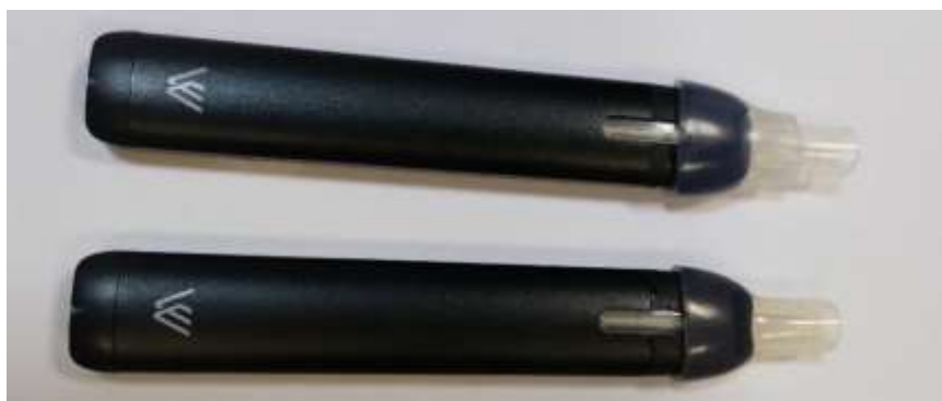
Рисунок 8 – СДН VON ERL Му с присоединенными силиконовыми трубками для тестирования на курительной машине
