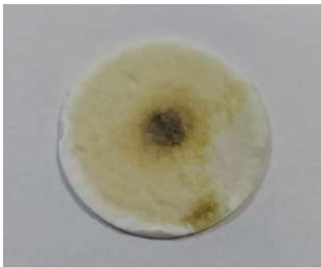
Рисунок 53 – Следы гари на фильтре после сбора аэрозоля с помощью СДН iKuu i200
