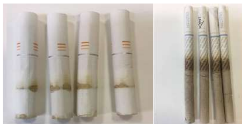
Рисунок 25 – Вид изделий с нагреваемым табаком (табака нагреваемого) – стиков после сбора аэрозоля ЭСНТ IQOS™ 2.4P (а) и ЭСНТ Glo (б)
