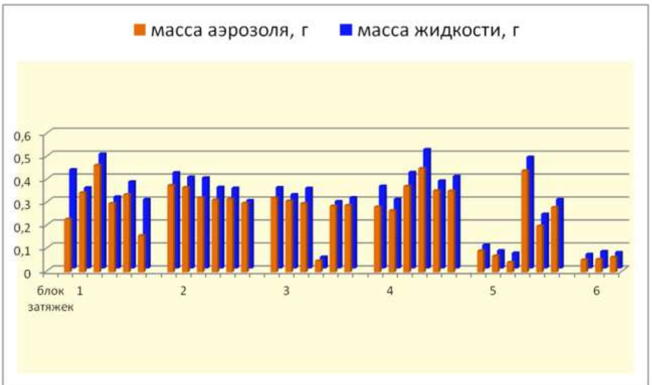
Рисунок 41 – Сбор аэрозоля с картриджами E3, E4, E2 с использованием СДН 9-14 по режиму CRM-81
