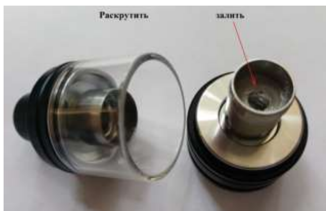
Рисунок 12 – Отвешие в испарителе для заливки жидкости для СДН
