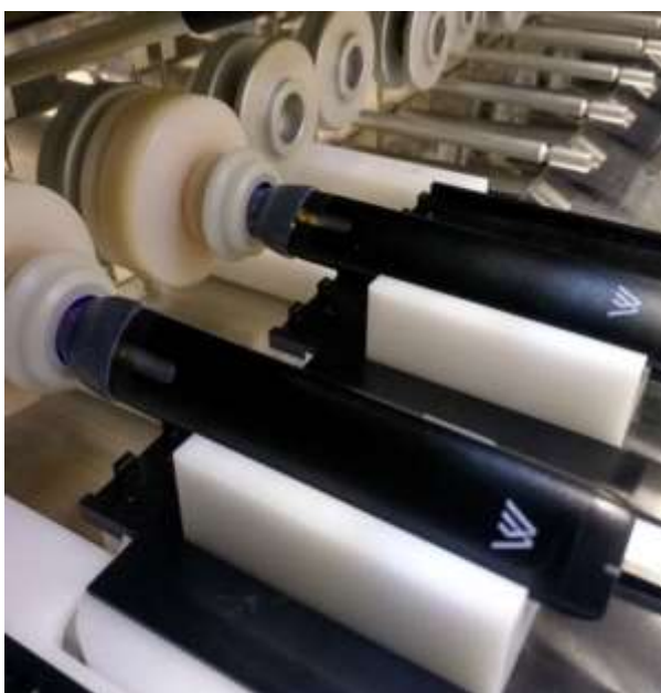
Рисунок 34 – Сбор аэрозоля СДН Von Erl Му на курительной машине
