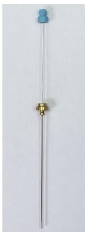
Рисунок В.2 – Фотография волокна ТФМЭ
