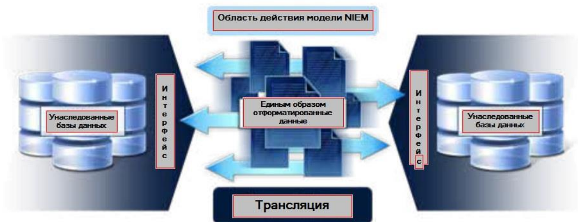
Рисунок 5 - Трансляция данных между унаследованными базами данных (существующими системами) с помощью NIEM
