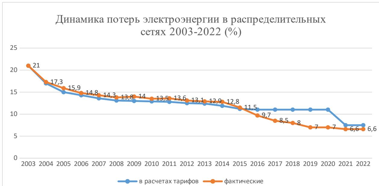
Рисунок 3: Динамика потерь электроэнергии в распределительных сетях 2003-2022 (%)
