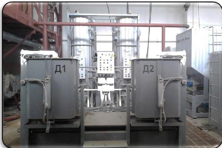
4. Декантаторы – предназначены для разделения твердых и полужидких отходов от влаги и механических примесей
