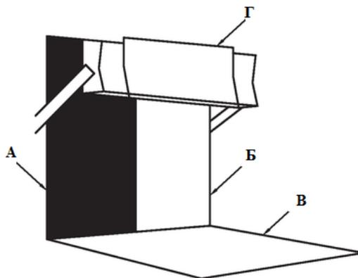
Рисунок номер-1 – Типовое устройство для просмотра видимых механических включений
