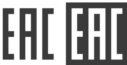
Рис. 6. Изображение Единого знака обращения продукции на рынке государств – членов Евразийского экономического союза
